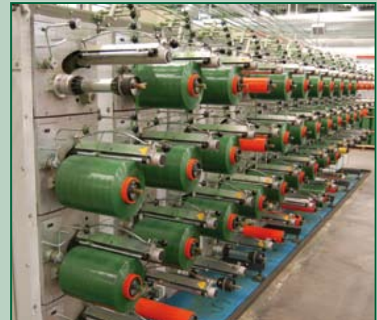
De folie wordt gesneden en gestrekt..... .....gefibrilleerd..... .....en op klossen gespoeld.
