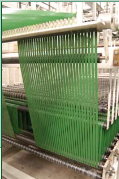
De folie wordt gesneden en gestrekt..... .....gefibrilleerd..... .....en op klossen gespoeld.
