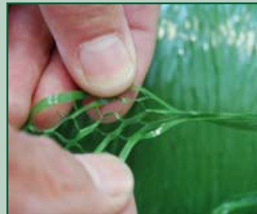
De folie wordt gesneden en gestrekt..... .....gefibrilleerd..... .....en op klossen gespoeld.
