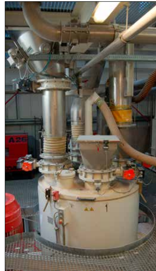
De warmmenger wekt door wrijving hitte op tot >100°C
