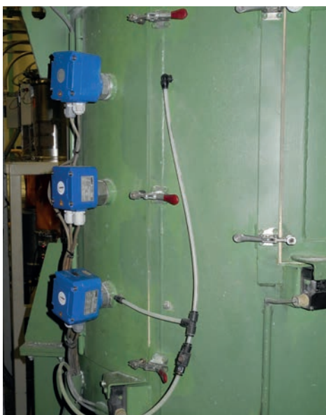
Afb. 3 Een vlokkenbin met drie draaivleugel niveaudetectoren van Nivothem
